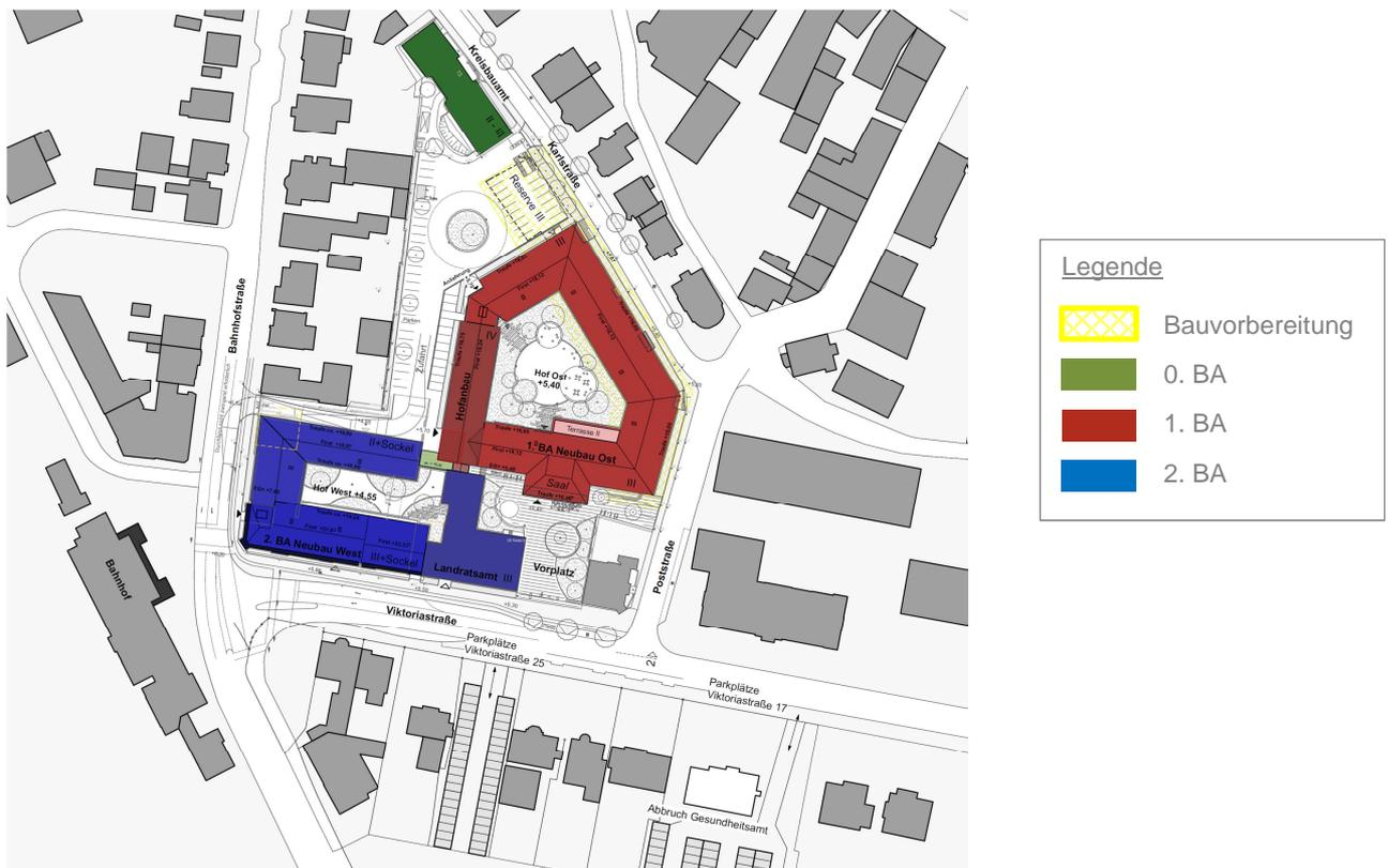
Abbildung 1: Darstellung Gesamtbaumaßnahme mit Bauabschnitten
