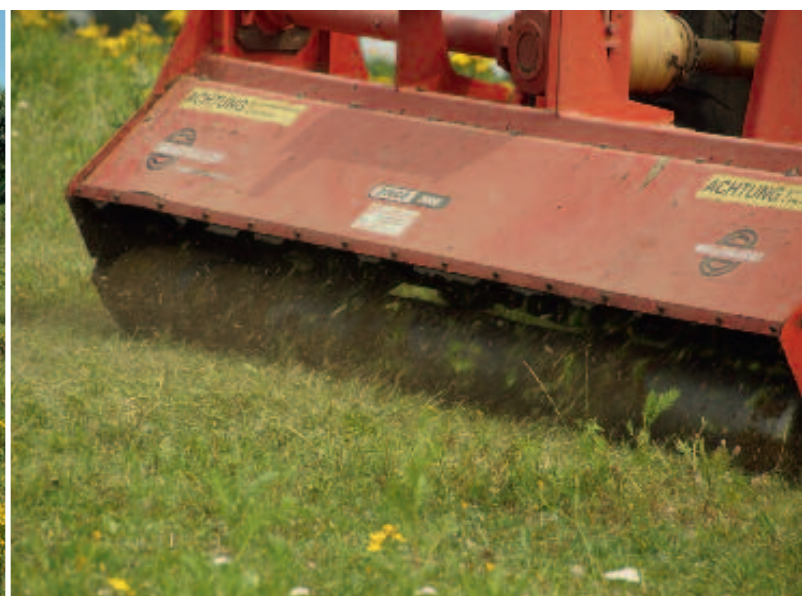
Die Kollateralschäden an Fauna und Habitatstrukturen sind bei der Mahd mit dem Doppelmesserbalken (links) deutlich geringer als beim Mulchen mit dem Schlegelmulcher (rechts). (Fotos: Aiko Huckauf)
